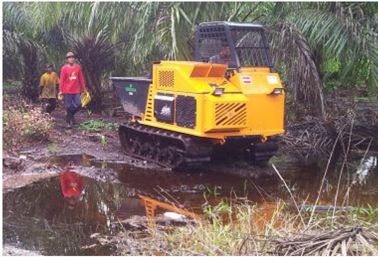
Gambar 2. Penggunaan Beluga di kawasan tanah gambut.
