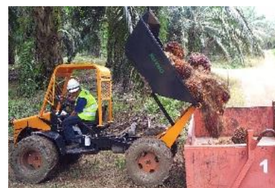
Gambar 4. Operasi penggunaan Rhyno sebagai jentera pengangkut BTS di ladang sawit.
