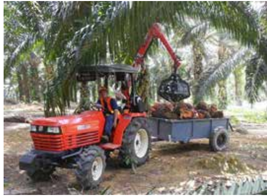
Rajah 5. Kerja-kerja memunggah BTS menggunakan pemunggah mekanikal yang dikenali sebagai The Grabbe di lorong tuai dan kemudian di punggah ke dalam bin yang sedia menunggu di tempat pengumpulan di jalan utama.
